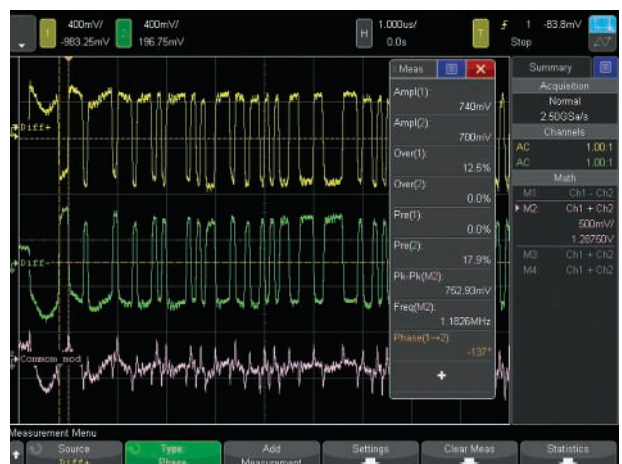
Figura 23: Saída de sinais arbitrários diferenciais dos dois canais do WaveGen. O modo comum é mostrado como uma função matemática.
