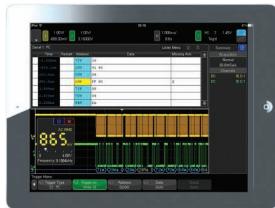
Figura 37: Controle pelo painel frontal virtual do tablet.
