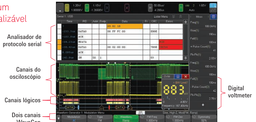
Figura 17: A série 4000X fornece os recursos de 5 instrumentos perfeitamente integrados em um.
