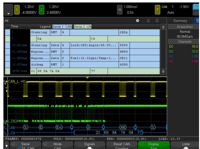
Figura 19: Decodificação dual de barramento serial CAN e LIN e exibição “em lista” intercalada.
