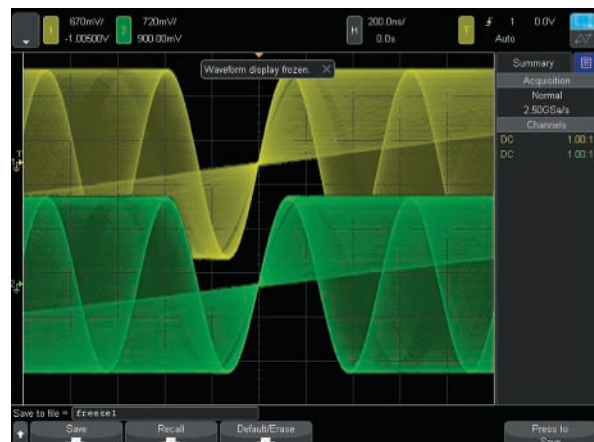
Figura 42: O recurso de “congelamento de tela” mantém a informação com gradação de intensidade, enquanto interrompe a aquisição de forma de onda.
