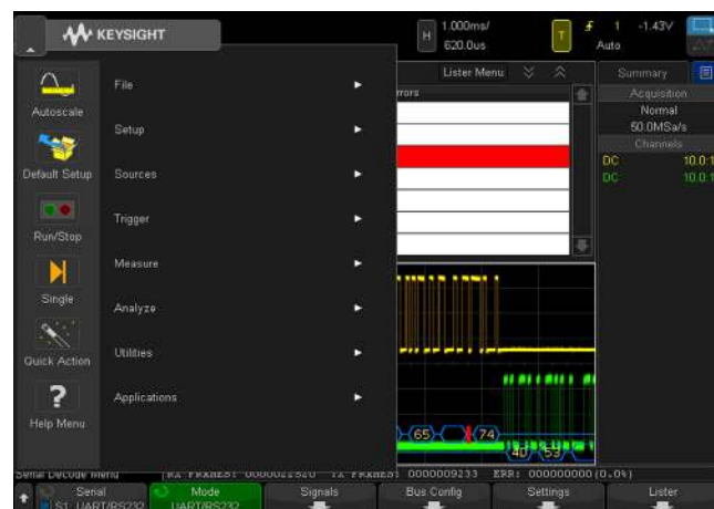
Figura 14: Utilize o menu deslizante da Keysight, para operação similar ao Windows.
