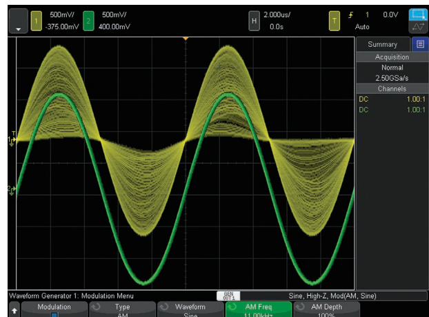
Figura 21: Saída de onda senoidal do WaveGen, com e sem adição de modulação AM.
