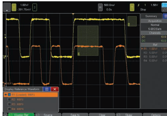
Figura 33: Armazene e utilize até quatro formas de onda de referência.
