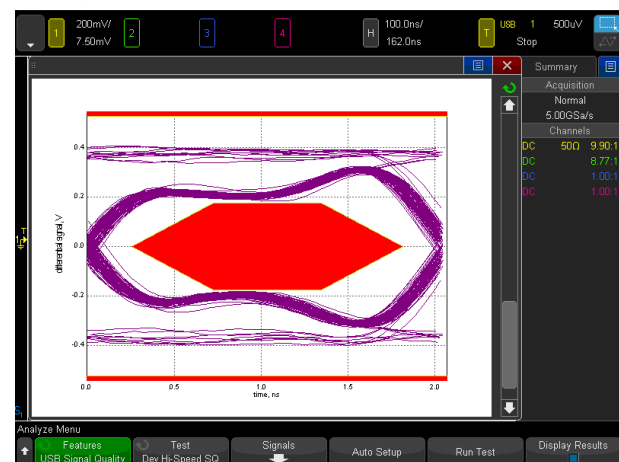
Figura 27: Faça testes de qualidade de sinais USB 2.0 low speed, full speed e hi speed.
