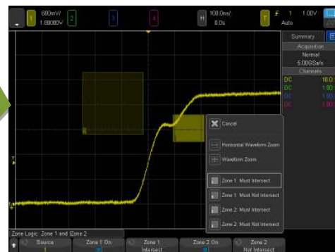
Figura 15. Quando você vê as anomalias, tudo o que você precisa fazer é desenhar uma caixa de região para disparar nelas.
