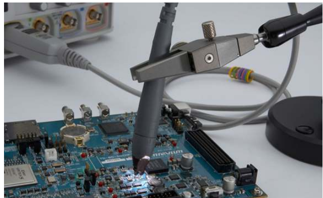
Figura 34: A ponta de prova InfiniiMode N2750A possibilita medições convenientes de sinais diferenciais, desbalanceados e de modo comum com apenas uma ponta de teste, sem necessidade de reconectar a ponta de prova para alterar a conexão.
