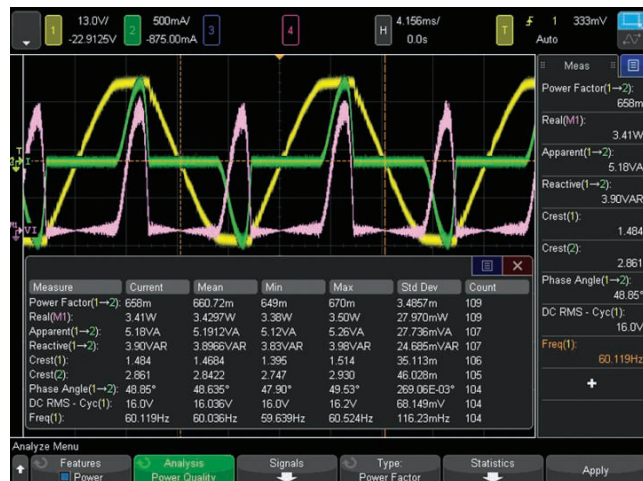
Figura 25: Medição de qualidade de potência, uma das muitas presentes na aplicação de medições de potência
