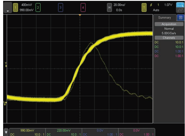
Figura 3: A série 4000X captura uma falha que ocorre uma vez a cada um milhão de ciclos de formas de onda.
