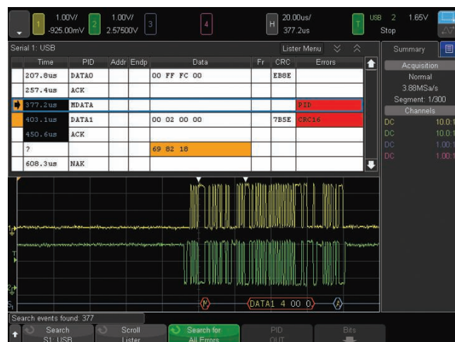
Figura 20: Disparo, decodificação e exibição “em lista” do USB 2.0
