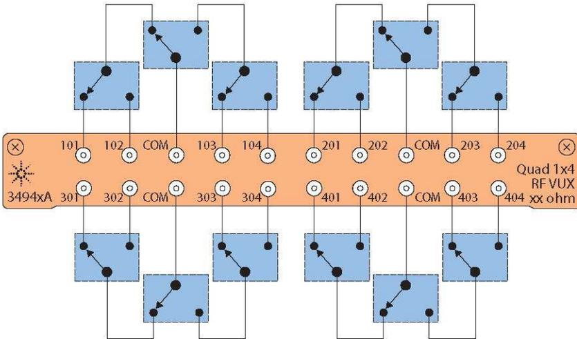
Figure 10. 34941A Quad 1x4 50 ohm 3 GHz multiplexer
